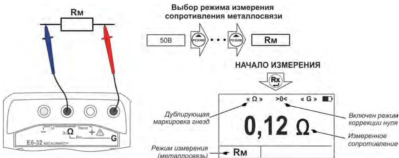
Рисунок 2.8 - Измерение сопротивления металlosвязи
