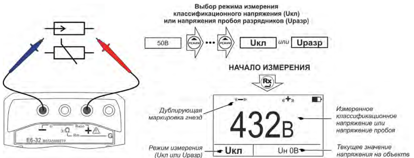
Рисунок 2.10 - Измерение классификационного напряжения или напряжения пробоя разрядников
